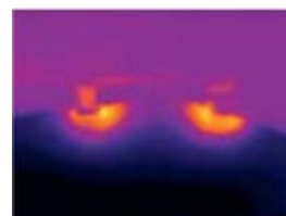
Rys. 8. Rozkład prądu elektrycznego dla systemu bipolarnego z dużą odległością między elektrodami.
